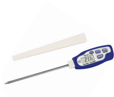
Termómetro para uso alimentario, que se basa en la variación de la resistencia eléctrica con la temperatura.
