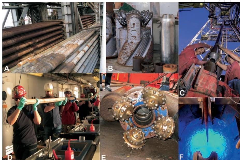
Figura 5. A, tubos de perforación. B y E, cabezales de perforación. C, sondistas colocando los tubos verticales en la torre de perforación. D, técnicos llevando al laboratorio los sondeos obtenidos. F, la «piscina», a través de la cual se bajan los tubos de perforación al fondo marino.
