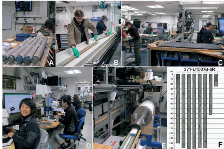
Figura 6. Laboratorios en el *Joides Resolution*. A, medición de aguas intersticiales. B, Los técnicos dividen los sondeos en dos mitades longitudinales para su muestreo y archivo. C, laboratorio de descripción sedimentológica. D, laboratorio de micropaleontología. E, medición de la polaridad magnética. F, fotografía de un sondeo, dividido en secciones de 1,5 m.
